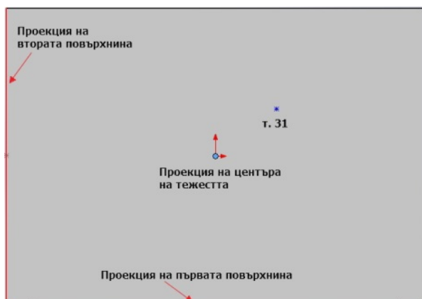
Фиг.10. Положение на точката за базиране по трета повърхнина спрямо проекциите на центъра на тежест, главната базираща и втора повърхнина.
