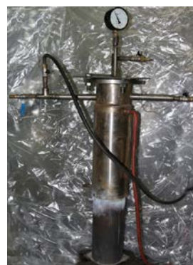
Рисунок 2 - Реактор для барботирования алюминий-магниевого расплава и расплава чистого магния ацетиленом
